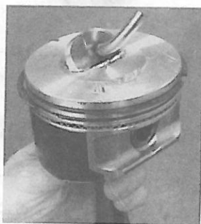
شکل ۱۱-۱۳- پیستون آسیب دیده در اثر برخورد با سوپاپ
