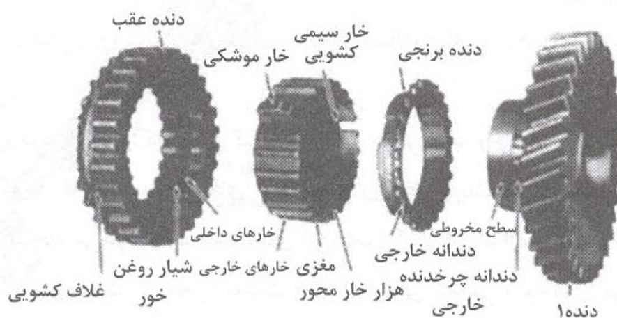
شکل (۱۲-۵): خارهای به کار رفته در گیربکس
