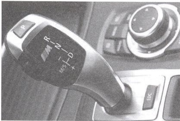
شکل (۲-۷) اهرم انتخاب دنده به صورت الف) مکانیکی ب) الکتریکی
