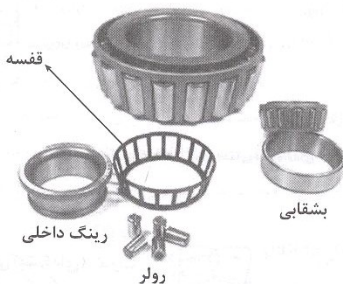
شکل (۳-۱۱) اجزا یاتاقان غلتشی غلتک مخروطی
